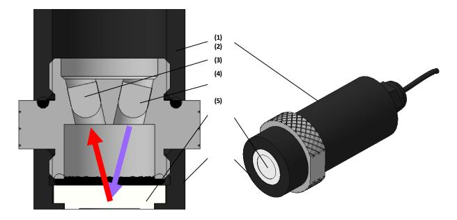
Измеритель состоит из компактного датчика в корпусе (1) расположены источник света (3), фотоприемник (2). Сменная насадка (4) с нанесенным красителем, фиксируется колпачком (5). а также измерительного преобразователя.
