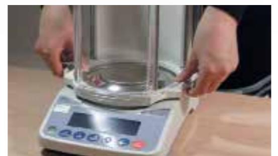
Удобные крепления для монтажа/демонтажа ветрозащитного бокса. Установка/снятие занимает не более 30 секунд
