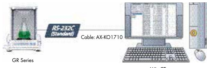
RsCom, RsKey и RsWeight позволяют пользователю выбрать время, дату, порядковый номер данных, интервал передачи данных, а также данные GLP/GMP. Файл readme содержит все установки и инструкции по работе, а также поиску и устранению ошибок.
